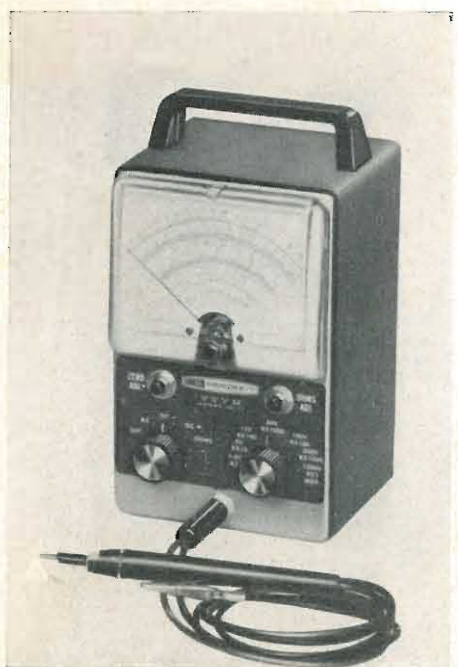
Ecco un secondo voltmetro elettronico della HEATHKIT: il modello IM-11, destinato a sostituire i ben noti V-7A e V-7AE. Di essi conserva le migliori caratteristiche, con una risposta di frequenza da 25 Hz a 1 MHz \pm 1 dB e uno strumento indicatore da 200 \mu A f.s.
