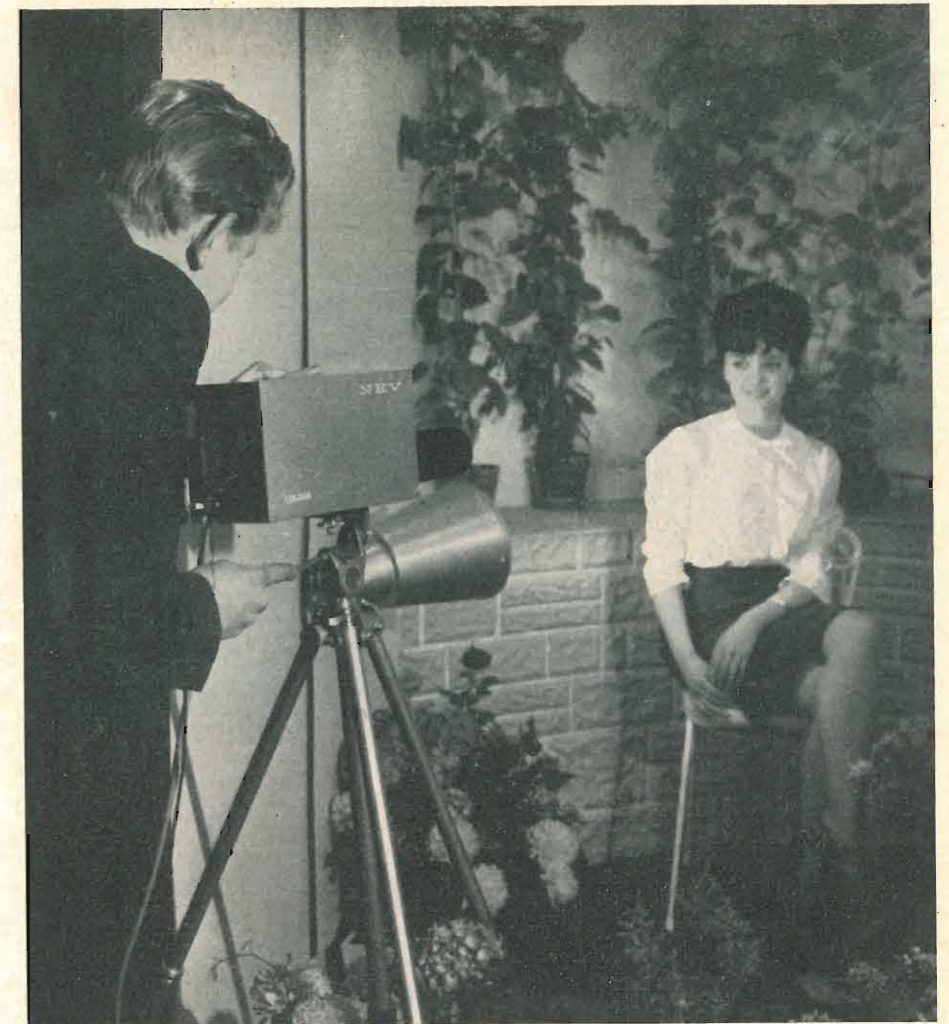
La NOTTINGHAM ELECTRONIC VALVE Co d'Inghilterra ha costruito una telecamera per televisione a colori in circuito chiuso di basso prezzo. La telecamera, che è completamente transistorizzata con pannelli a circuiti stampati si presenta particolarmente adatta per installazioni ove lo spazio è ridotto e in cui non sia possibile far ricorso alle normali telecamere a colori.
